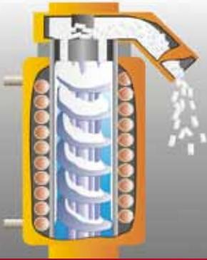
Un husillo gira dentro del cilindro evaporador, el cuál se llena con agua y se refrigera desde el exterior. El agua se congela en la superficie interna del cilindro en pequeñas partículas de hielo, las cuáles se raspan mediante el husillo evaporador y se transporta hacia arriba. El hielo pasa a través de un filtro lo que le da su forma característica granulada.
