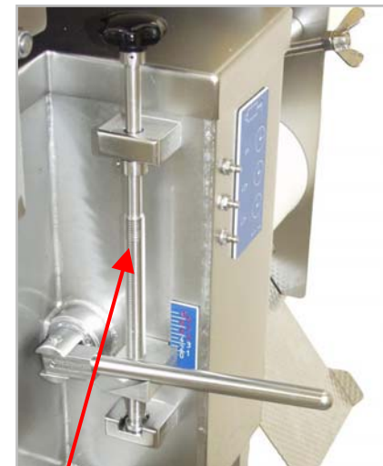
Einfaches Einstellen des Anpressdruckes, ablesbare Druckeinstellung Easy adjusting the pressure system, readable pressure of pressure roller Легкая регулировка системы прижима, считываемые показания давлений прижатия прижимного валика
