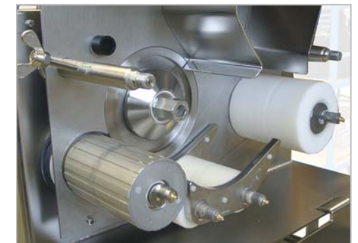
Hohe Ausbeute und Lebensdauer durch stabile Bandlagerung High yield and long life thanks to stable belt bearing Высокий выход и большой срок службы обеспечивается устойчивыми опорами ленты
