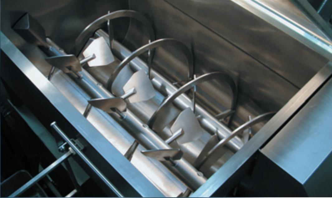
Die Industriemischer für höchste Ansprüche. Materialschonendes und exaktes Mischen, Standardisieren und Homogenisieren von großen Chargen. Durch die glanzpolierten, fugenlosen Oberflächen, lassen sich die Maschinen besonders leicht reinigen und entsprechen allen internationalen Hygiene- und Sicherheitsvorschriften.
