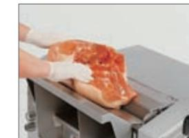
La instalación adicional (sin herramientas) de un soporte de cuchilla permite la separación de la corteza de la grasa y la separación de la grasa de la carne; logrando de esta manera un proceso más fácil y un mayor rendimiento.
