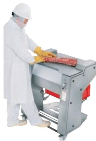
Máquinas de alto rendimiento y durabilidad, anchuras de corte 434 y 554 mm, limpieza del rodillo dentado por aire comprimido. Desarrolladas para cumplir los estrictos requisitos de la industria del procesado de carne:
